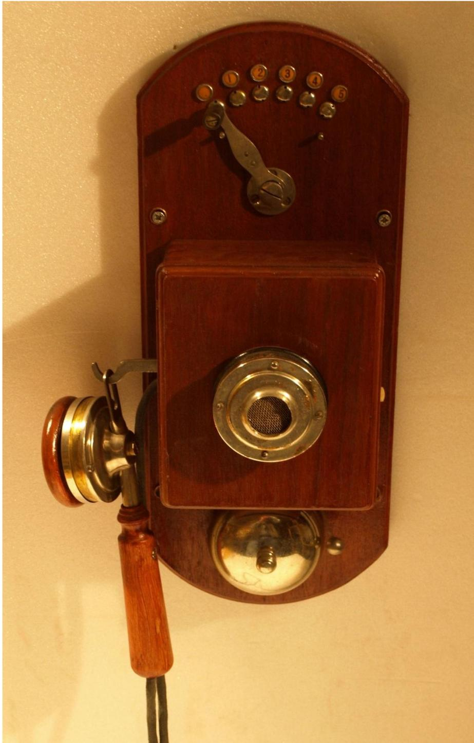
**Haus-Telephon-Apparate, Kurbelwähler. Wandstation Nr. 6000/5 mit Kurbelschalter und 5 Einstellraste, automatischem Hakenschalter, Gleichstromwecker, Rufknopf, Induktionsspule, drehbarem Kohlepulver-Mikrofon, einfachem Stieltelefon und polierter Holzurückwand. Diese Station wird für 5, 10 und 15 Einfachleitungen gebaut. (TEFAG Katalog 1925)**
